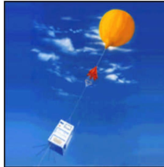
Radiosondengespann mit Ballon, Fallschirm und Radiosonde (nicht DWD)
